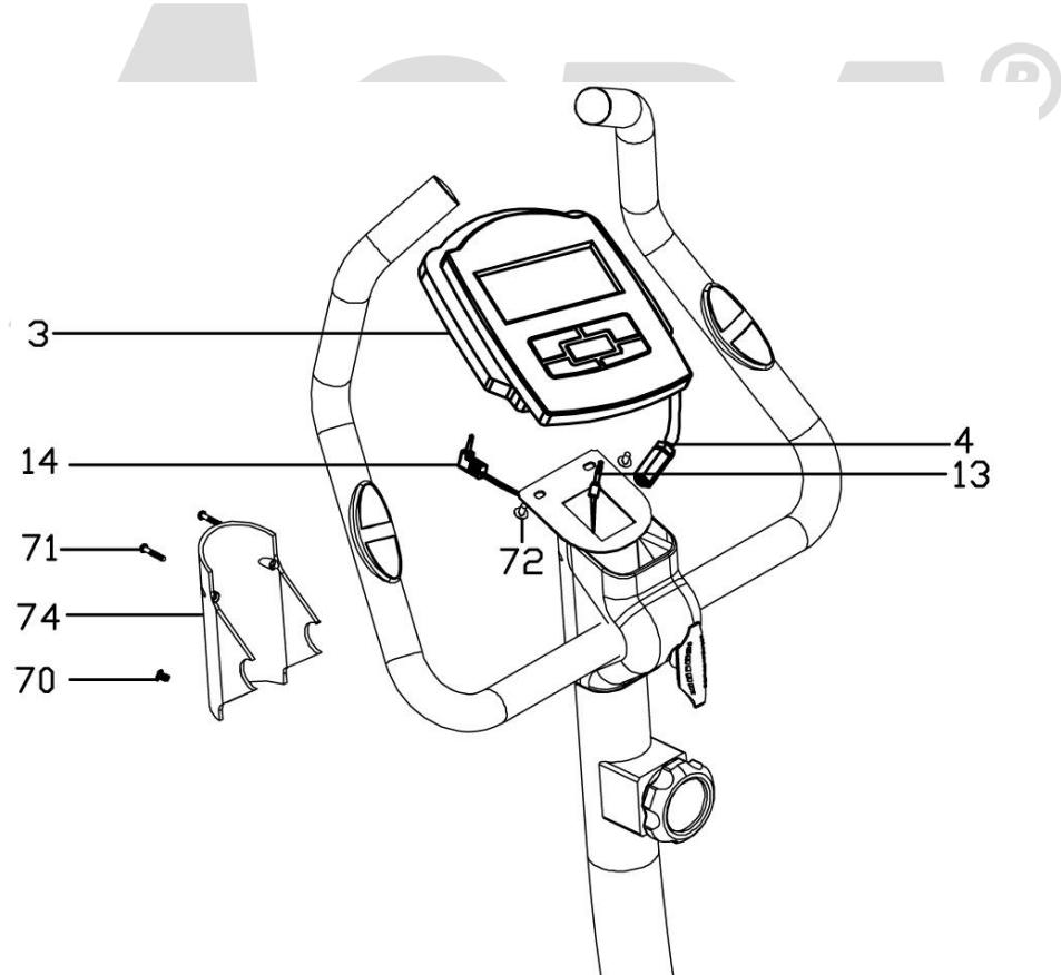
Zatímco vám někdo přidržuje počítač (3), připojte horní kably (13) ke kabelům (4). Vložte kabelové svazky do řídítkové části. Připojte počítač na sloupek rukojetí pomocí šroubů (72). Dávejte pozor, aby se nesevřely kabelové svazky! Připojte snímač pulsů do konektoru na zadní straně počítače. Upevněte zadní kryt rukojetí (74) s předním krytem rukojetí (75) pomocí šroubů M4 (71) a šroubů M5 (70).
