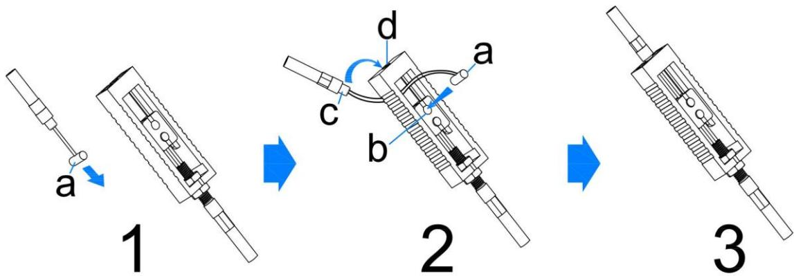
Vložte koncový kolík (a) do malého háčku (b). Zatáhněte kabel kolíku (c) skrz hák (d). Ujistěte se, že koncový kolík (a) je dobře vložen do malého háčku (b) a kabel kolíku (c) nevypadává z háku (d).
