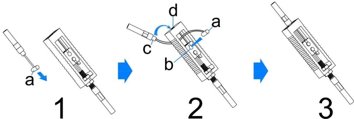
Vložte koncový kolík (a) do malého háčku (b). Zatáhněte kabel kolíku (c) skrz hák (d). Ujistěte se, že koncový kolík (a) je dobře vložen do malého háčku (b) a kabel kolíku (c) nevypadává z háku (d).
