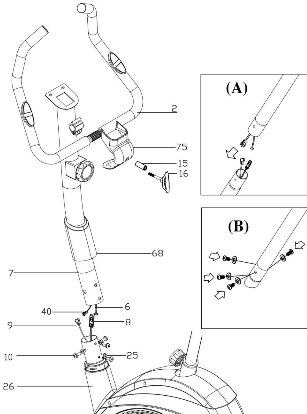
Zatímco vám někdo přidržuje přední řídítkovou část ve vzpřímené poloze, připojte prostřední kably (40) k dolním kabelům (9). Opatrně zasuňte sloupek rukojetí (7) do rámu (26). Dávejte pozor, abyste nepřerušili spoj kabelů. Připevněte sloupek rukojetí k rámu pomocí 4 šroubů M8 (10) a 4 podložek M8 (25).
