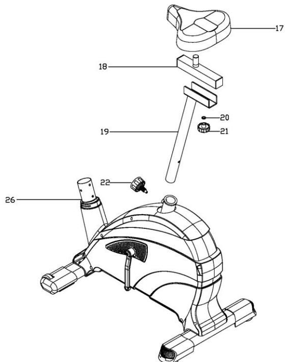
Vložte sloupek sedla (19) do rámu (26). Přizpůsobte otvor v sedlové trubce otvoru v rámu. Vložte regulátor nastavení sedla (22) do otvoru rámu a sedlové trubice a utáhněte jej. Ujistěte se, že jste umístili regulátor do otvoru nosníku sedla.
