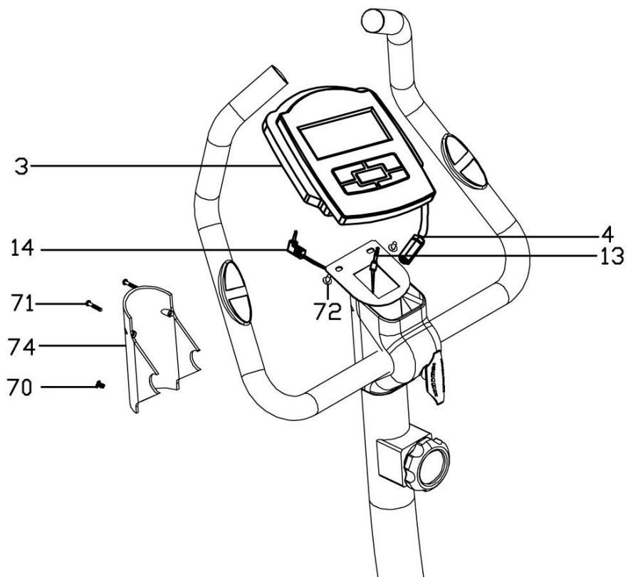
Zatímco vám někdo přidržuje počítač (3), připojte horní kabely (13) ke kabelům (4). Vložte kabelové svazky do řídítkové části. Připojte počítač na sloupek rukojetí pomocí šroubů (72). Dávejte pozor, aby se nesevřely kabelové svazky! Připojte snímač pulsů do konektoru na zadní straně počítače. Upevněte zadní kryt rukojetí (74) s předním krytem rukojetí (75) pomocí šroubů M4 (71) a šroubů M5 (70).
