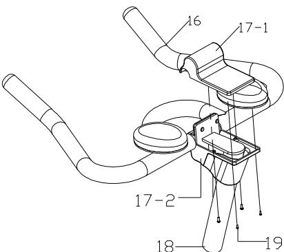
Krok 7: Přiložte horní kryt řidítka (17-1) a spodní kryt řidítka (17-2), překryjte jimi řidítka (16) a představec (18) a kryty upevněte pomocí šroubů (19).
